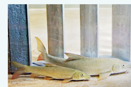
Image : les barreaux pourraient nager à travers les barreaux sans problème. Cependant, le dispositif de guidage produit des turbulences qui les maintiennent à distance. Les poissons sont guidés ainsi à l'écart des turbines. Photo: Eawag
