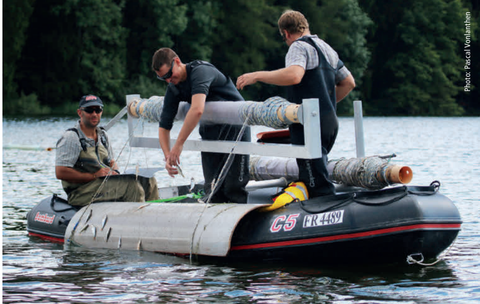
▲ Figure 4 : Échantillonnage standardisé à l'aide des filets verticaux utilisés dans toute la Suisse dans le cadre du « Projet Lac ».
