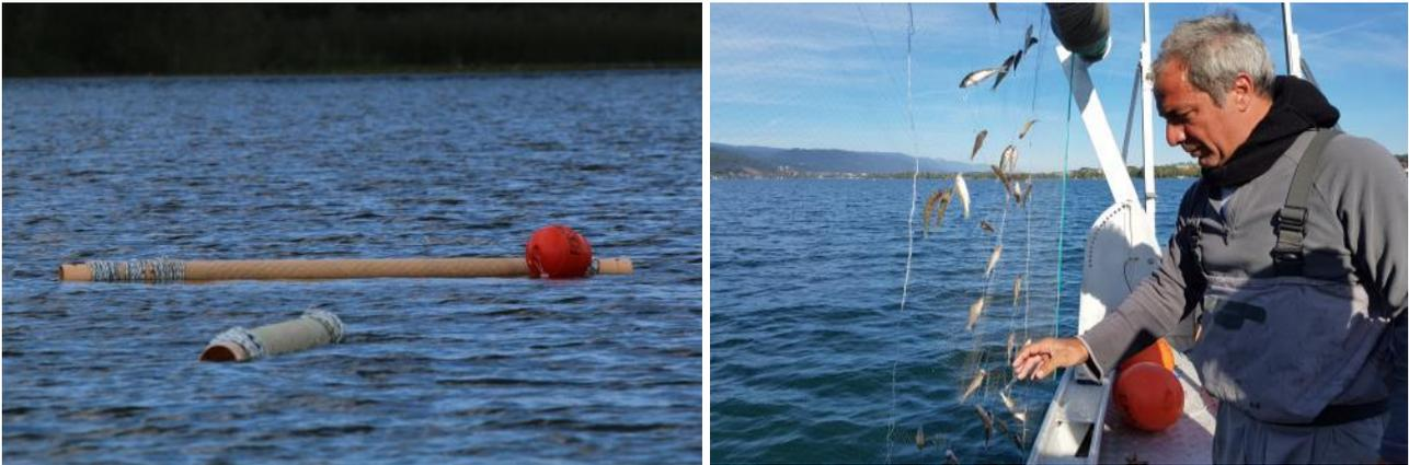
**Abbildung 3-1.** Links: Vertikales Multimaschennetz abgewickelt von einem Schwimmkörper. Darunter fischt das Netz die gesamte Seetiefe vom Seegrund bis zur Oberfläche. Rechts: Entnahme der Fische aus einem Vertikalnetz. Dabei wird nebst der Art und der Länge auch die Tiefe, in denen die Fische gefangen wurden, erfasst.
