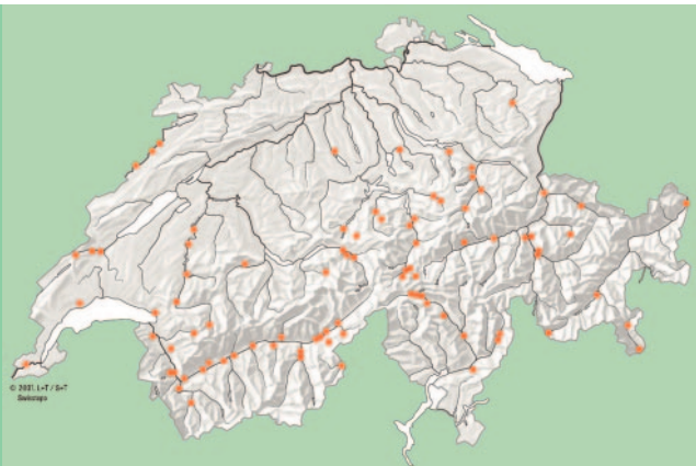
Fig. 2: Situation géographique des centrales hydroélectriques (> 300 kW) fonctionnant par éclusées en Suisse (extrait de 3).
